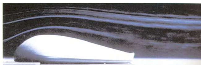
Моделирование ветрового воздействия на купол стадиона в зимний период
